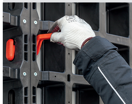
將 DUO 鎖扣插入槽孔中並旋轉90°
