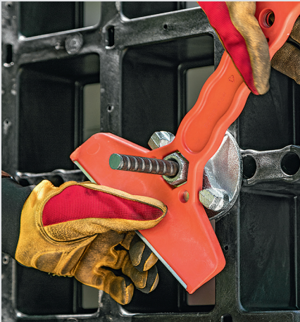
實用技巧：此清潔工具也可以用來擰緊螺母盤帽。
